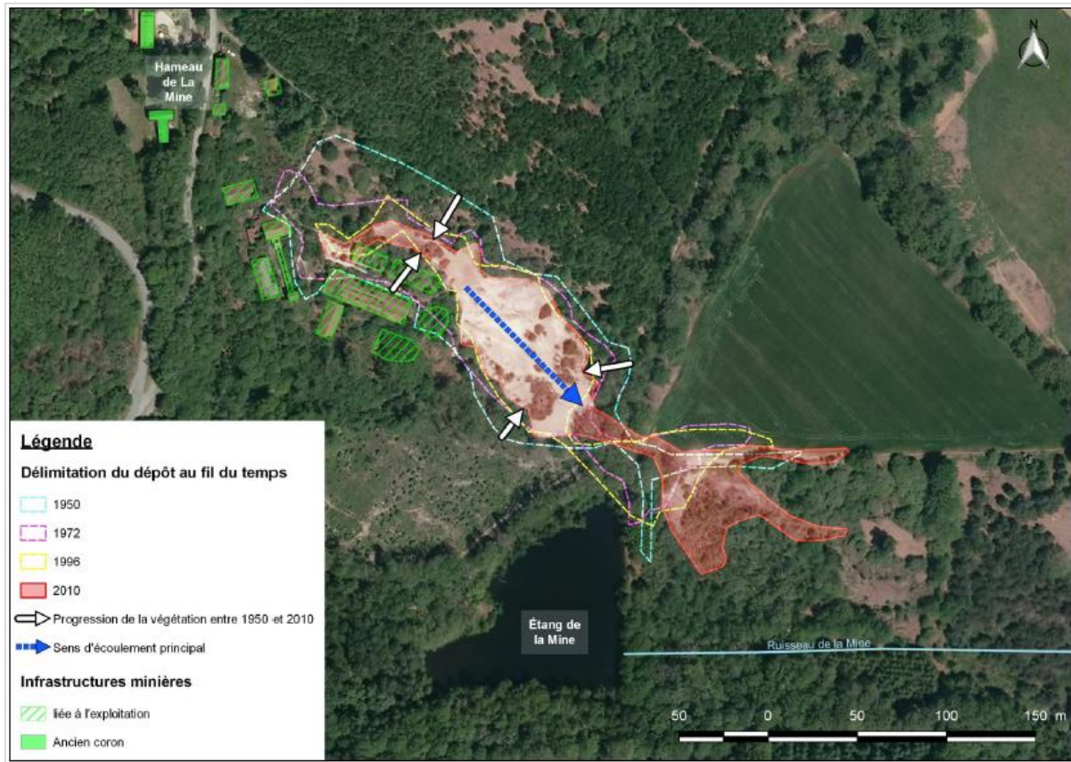
Figure 7 : Evolution du dépôt de résidus de traitement depuis l'arrêt de l'exploitation 1960-2010
